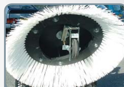
RUEDA DELANTERA Ø 120 mm AJUSTABLE EN ALTURA OMNIDIRECCIONAL
